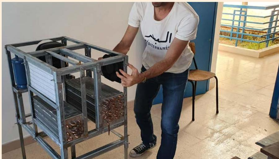
Selon Kumulus Water, cofondée et dirigée par Iheb Triki, il y a 6 fois plus d'eau dans l'air que dans les rivières. Il suffit d'extraire cette eau en refroidissant de l'air au-dessous de son point de rosée et en l'exposant à des absorbeurs d'humidité ou en la pressurant pour rendre l'eau potable.
